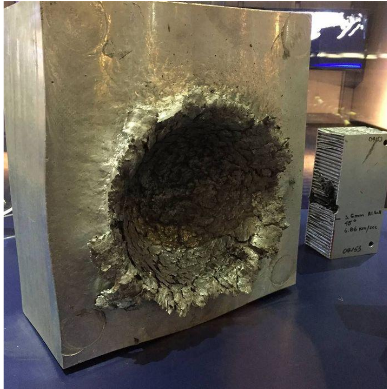
Fig. 7 Photographie d'un bloc d'aluminium (épaisseur 20 cm) ayant subi en laboratoire l'impact d'un projectile en plastique de 14 grammes lancé à 24 000 km/h. Cet essai présenté en 2018 démontre l'importance des éléments de protection contre les météorites. Source : bighink.com
