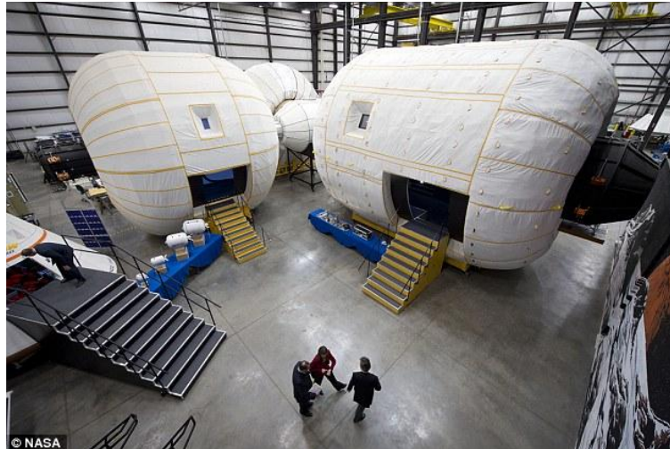
Fig. 20 Prototypé d'habitat lunaire gonflable de la société Bigelow Aerospace (2013). Un ensemble de modules gonflables sont connectés pour créer un volume habitable important. Source : www.dailymail.co.uk
