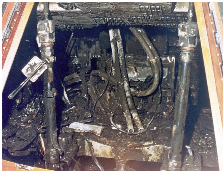
Fig. 6 Photographie du module de commande de la mission Apollo 1, après son incendie (provoquée en atmosphère d'oxygène pur, 1967). Cet événement a coûté la vie aux astronautes Virgil Grissom, Edward White et Roger Chaffee et a foncièrement changé les procédures de gestion de l'atmosphère dans les missions spatiales habitées suivantes. Source : www.universetoday.com
