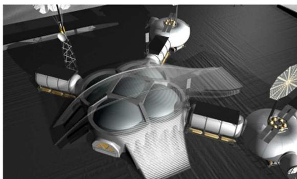
35. 3D de la base montrant les modules et leurs protections de régolithe, © NASA Sinterhab
