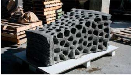
imprimeuse dépose successivement des couches de 4 mm de régolithe puis imprime avec une « encre » non-organique à base d'oxyde métallique et de chlorure de magnésium. Ces éléments sont introuvables sur la Lune : il faut donc utiliser le moins de substrat possible par volume de régolithe. De ce fait, les couches sont imprimées de telle sorte à former une structure « éponge ».
