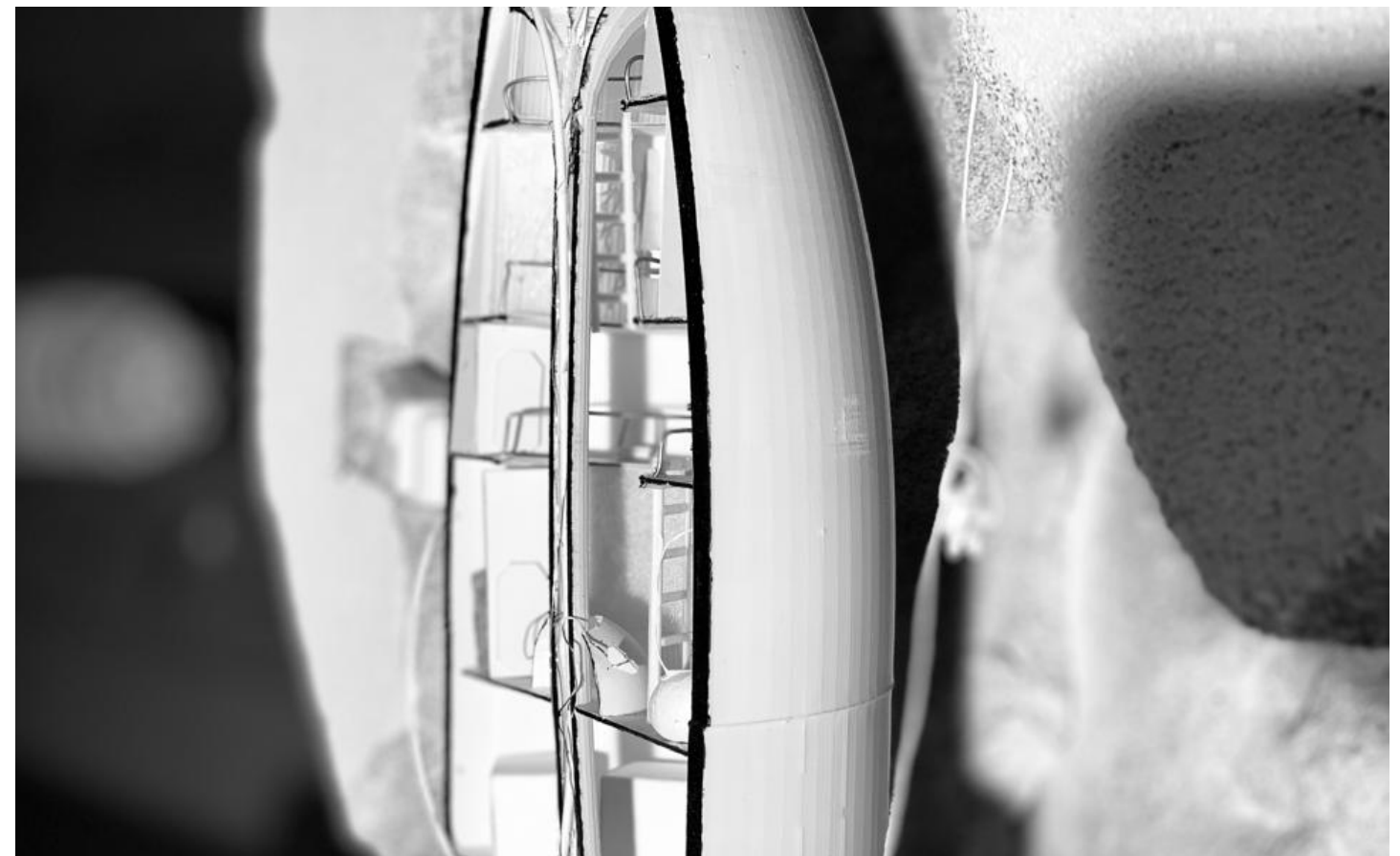
HABITER MARS // PHASE 2 ARRIVÉE À MARS À L'INTÉRIEUR DU TUBE DE LAVE MAQUETTE DE COUPE À L'ÉCHELLE 1/100 COQUE IMPRESSION 3D, SITE SCULPTÉ EN BÉTON CELLULAIRE, AJOUTS À LA MAIN
