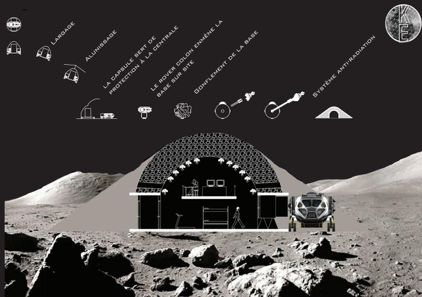
// Les bases mères gonflables sont renforcées avec un matériau local: la régolithe. Les 2m d'épaisseur garantissent une bonne protection contre les radiations solaires et les chutes de météorite de taille moyenne.
