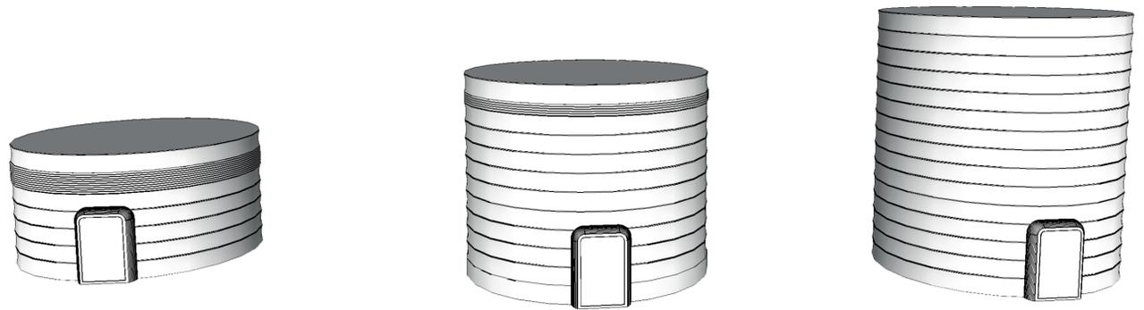
La base lunaire sera un module déployable en hauteur de 7m de diamètre. Compactée, elle ne mesurera que 3,20m de haut, et déployée elle mesurera 7,20m de haut. Un SAS déployable sera installé afin de gagner de la place à l'intérieur.
